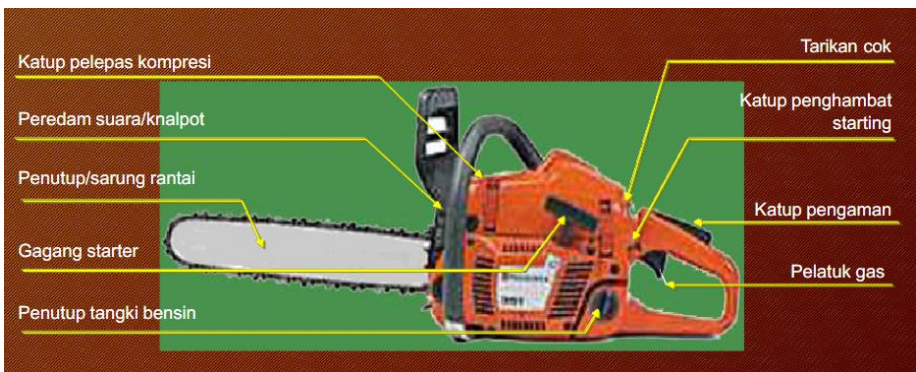
Gambar 1. Chainsaw dan bagian-bagiannya (Sumber: www.google.com )
