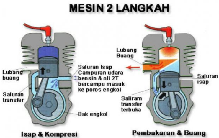
Gambar 1. Cara Kerja Mesin 2 Tak (Langkah)
