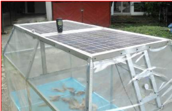
Gambar.1 Skema atap kolektor aktif dengan terintegrasi PV/T
