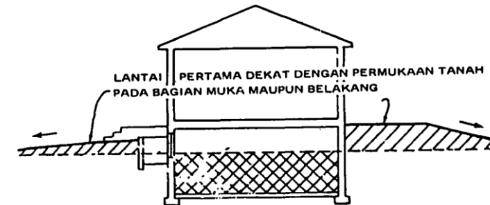
Gambar 1-18 Rumah pada tanah yang datar; tanah yang digali dimanfaatkan kembali untuk menaikkan landaian di sekeliling rumah. Cara ini mengurangi galian yang disyaratkan dan mengarahkan drainase menjauhi rumah.
