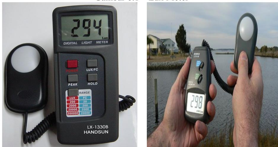
Menurut SNI 16-7062-2004 tentang Pengukuran Intensitas Penerangan di Tempat Kerja, pengukuran intensitas penerangan di tempat kerja menggunakan alat *luxmeter*. Alat ini mengubah energi cahaya menjadi energi listrik, kemudian energi listrik dalam bentuk arus digunakan untuk menggerakkan jarum skala. Untuk alat digital, energy listrik diubah menjadi angka yang dapat dibaca pada layar monitor.
