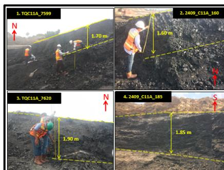
Gambar 7. Pengukuran ketebalan seam C11A daerah penelitian
