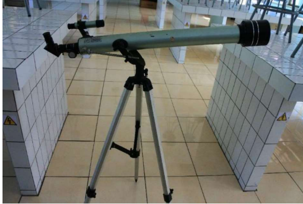
Teleskop Keplerian yang tersusun dari dua lensa cembung
