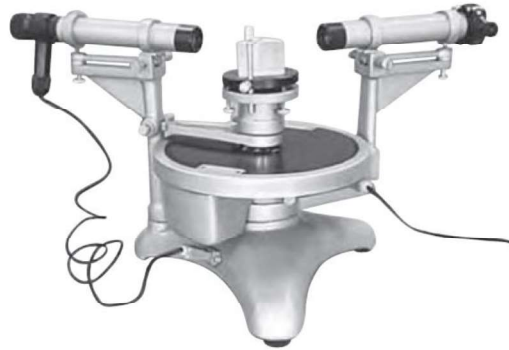
Gambar 2.18 Spektrometer prisma. Cahaya yang diarahkan ke tabung kolimator di sebelah kiri dibiaskan oleh prisma ke teleskop yang dapat disesuaikan di sebelah kanan. Kolimator memiliki sumber cahaya built-in, dan skala pengukuran bersudut memiliki skala lebih tinggi yang dapat dibaca hingga 1 menit busur. (Sumber: Wilson, 2015).
