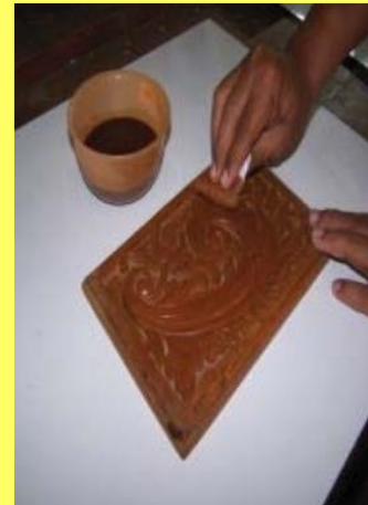
Gambar. Proses politur dasar, pengampelasan secara ambang & searah serat, serta politur akhir dengan kain perca.
