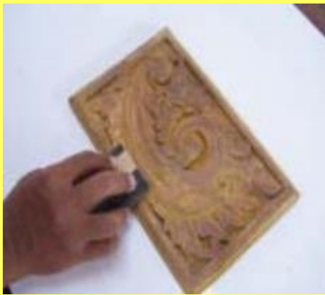
Gambar. Proses pengampelasan membersihkan permukaan, pengisian pori dengan oker atau dempul, pengampelasan bekas oker/dempul.
