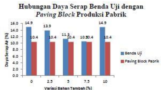
Grafik 4 Hubungan Daya serap Benda Uji dengan Paving block Pabrik
