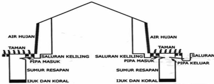
Gambar 4.2. Sumur Resapan Batu Belah dan Ijuk(Sharoeil 2010)
