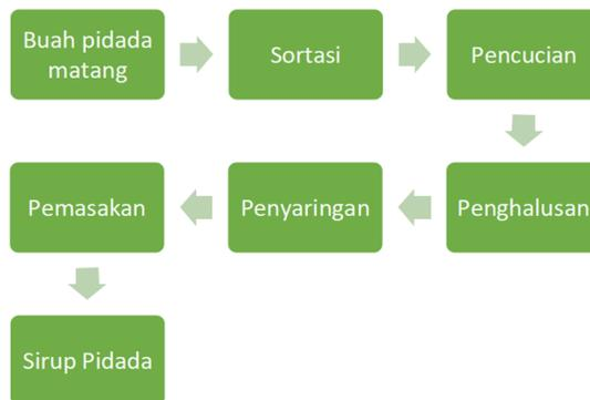
Gambar 2. Diagram Alir Proses Pengolahan Sirup Pidada
