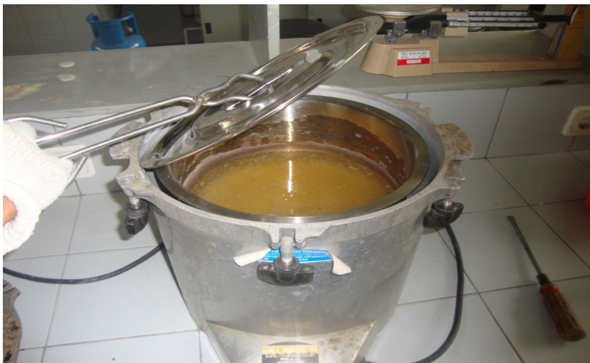
Gambar 11. Proses deasetilasi kitin menjadi kitosan
