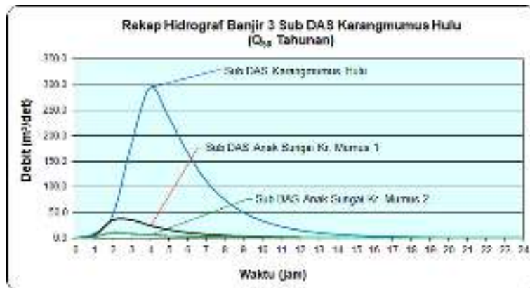
Gambar 3 Hidrograf Banjir 3 Sub DAS yang ada di Hulu Bandara APT Pranoto Sumber: Hasil Analisa (2022)
