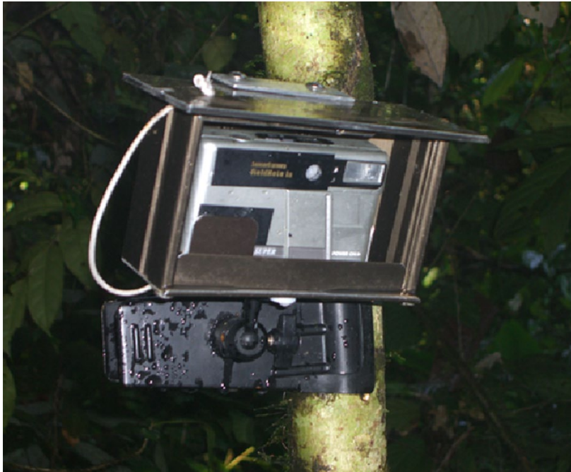
Model kamera otomatis yang digunakan dalam studi mamalia besar di koridor Gunung Beruiun
