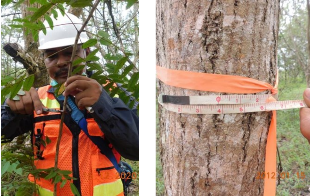
Gambar 5. Pengukuran Diameter Setinggi Dada (1,30 m dari Permukaan Tanah) pada Vegetasi Tingkat Pancang dengan Menggunakan Mikrokaliper dan pada Vegetasi Tingkat Pohon dengan Menggunakan Phi-band
