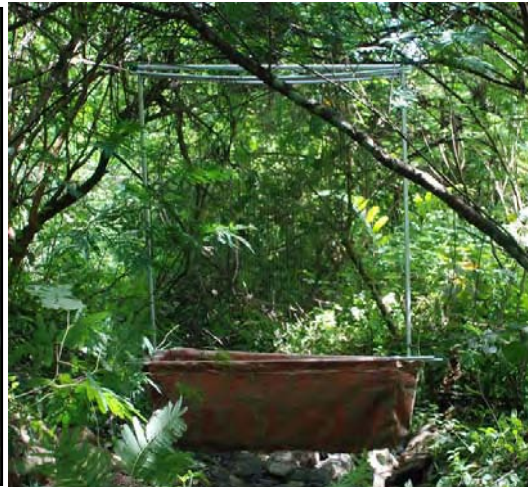
Gambar III-07. Perangkat harpa yang digunakan untuk menangkap kelelawar
