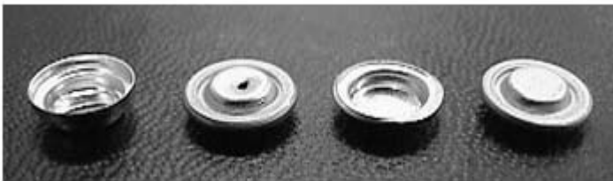
Gambar 6.2. Berbagai jenis panci DSC (Sumber: Clas dkk. [15]). Gambar diambil atas izin dan kebaikan dari Elsevier.
