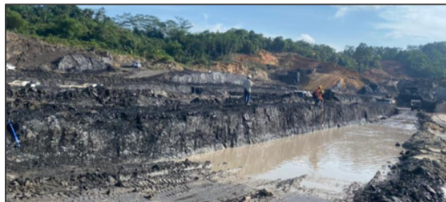
Gambar 6. Kondisi front penambangan yang tergenang air
