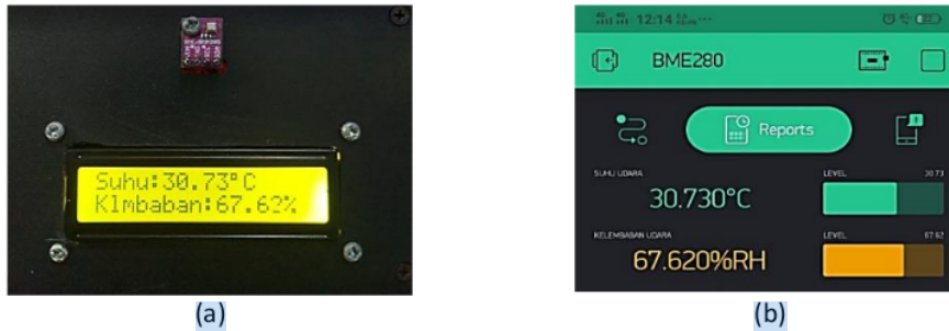
Gambar 9. Pembacaan suhu dan kelembaban: (a) LCD, (b) BLYNK
