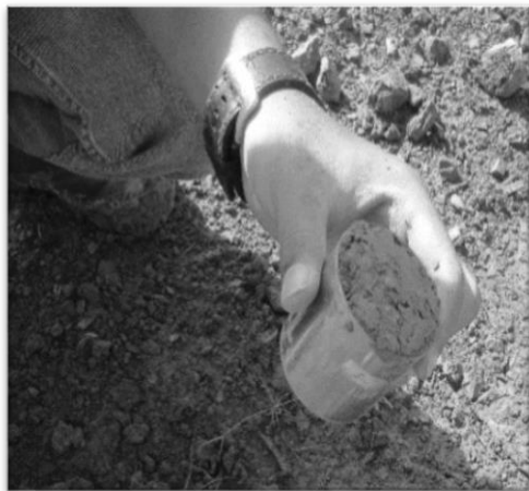
Gambar 1 Sampel tanah dalam soil sampling ring
