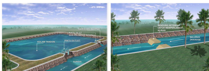
Gambar 9.9: Ilustrasi Kolam retensi untuk Drainase
