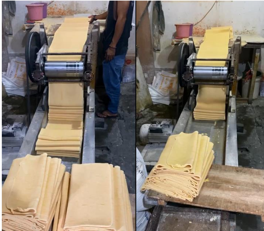
3. Mie yang pipih kemudian dibuat lebih tipis lagi di mesin penggilingan
