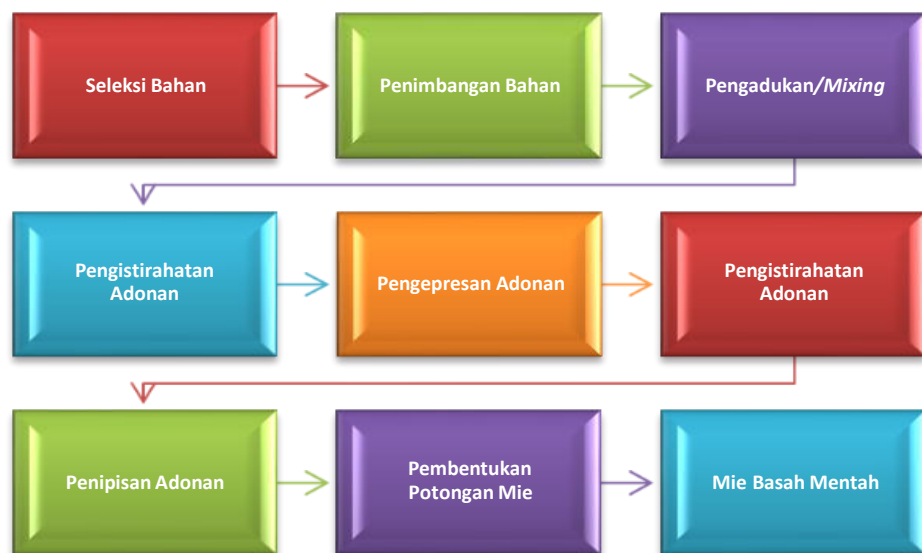
Gambar 4.3. Diagram Alur Pembuatan Mie Basah
