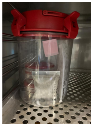
Anaerobic jar diletakkan di incubator
