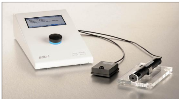
Gambar 3. Mexameter, alat untuk mengukur indeks melanin.
